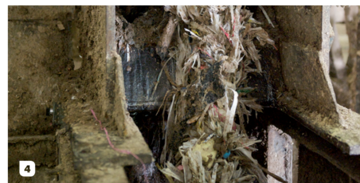
1. Balles d'emballages papier-carton usagés - 2. Convoyage des emballages usagés - 3. Pulpeur - 4. Toron
